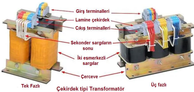
Şekil 5 Bir ve üç fazlı çekirdek tipi transformatörler
