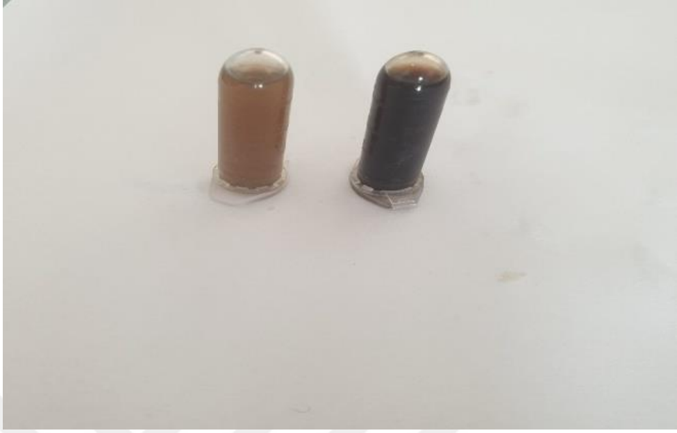
Şekil 3.2. Reaksiyondan sonra AgNP'lerin oluşumuna bağlı meydana gelen renk değişimi
