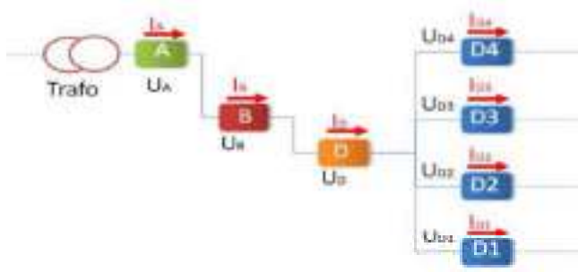
Şekil 8. Bir transformatör bölgesine bağlanan sayaçların bağlantısı
