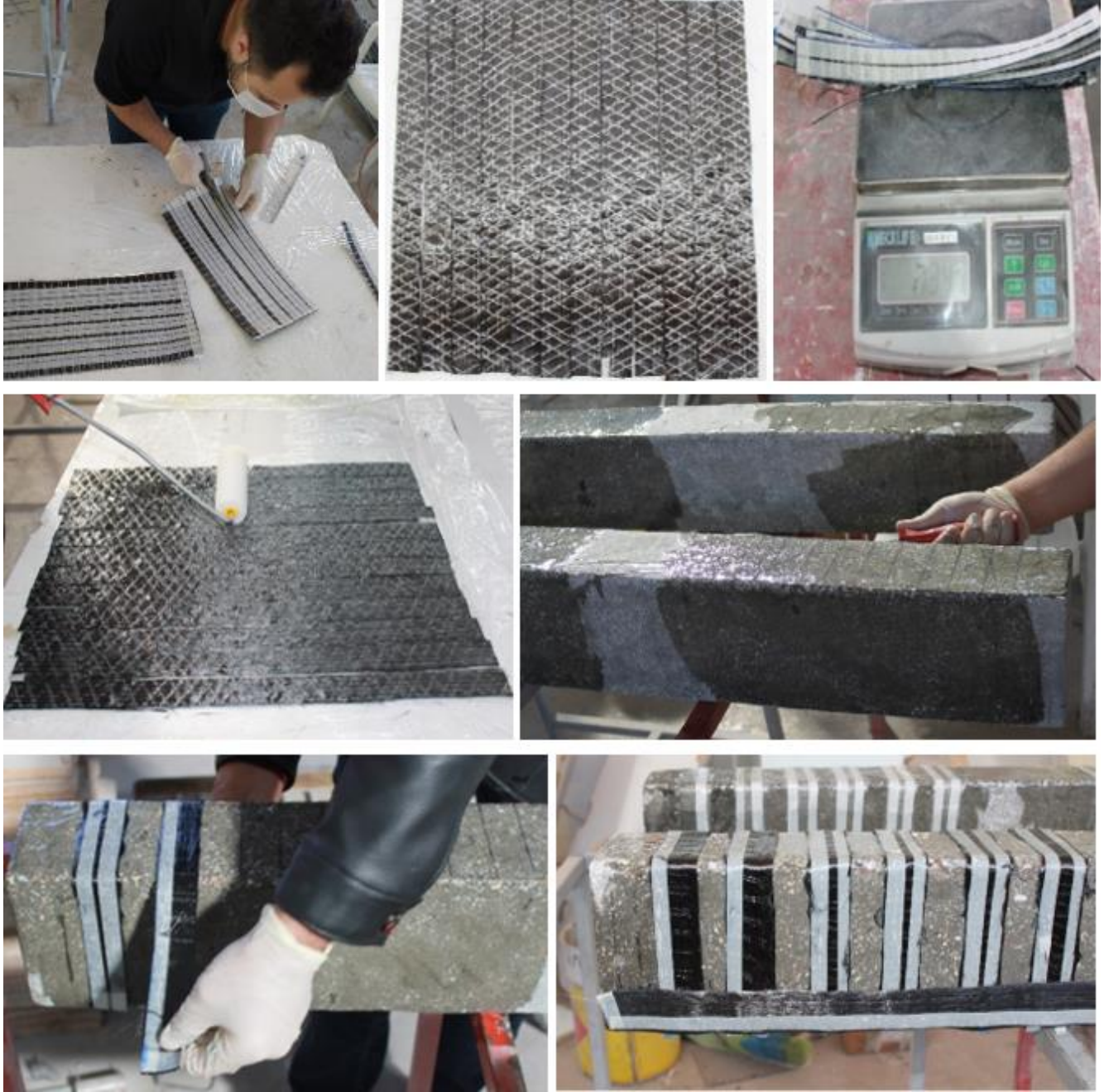
Şekil 2. CFRP şeritlerin beton yüzeye uygulanması
