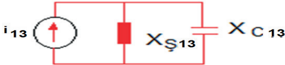
Şekil 11. On üçüncü harmonik bileşen için eşdeğer devre
