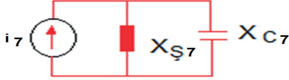
Şekil 9. Yedinci harmonik bileşen için eşdeğer devre
